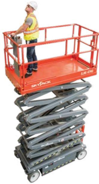
构造坚固，所有的主要零部件均易于检修，零部件通用于各种产品系列。模块化平台栏杆可以更换，再加上Skyjack各个型号所独有的彩色编码和编号布线系统，所有这些特性结合在一起就能最小化停机时间，保证设备长期租出，这就意味着更高的利润。
